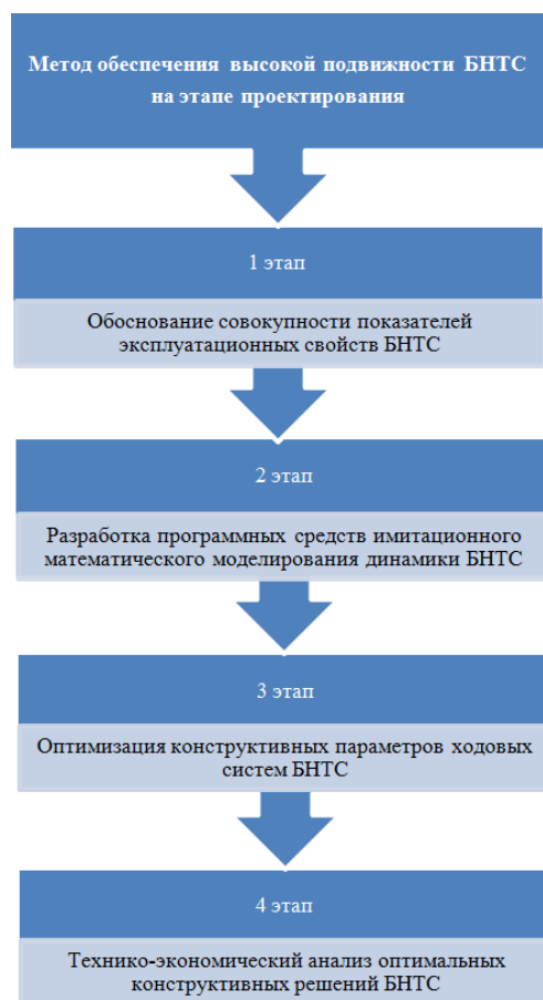
Рис.2. Структурная схема реализации метода обеспечения подвижности
